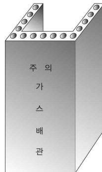
그림 2.5.7.3.2(3) 철근콘크리트재 방호구조물 예시
