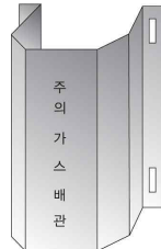
그림 2.5.7.3.2(1) 방호철판을 사용한 방호구조물 예시
