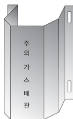
그림 2.5.7.3.2(1) 방호철판을 사용한 방호구조물 예시
