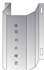
그림 2.5.7.3.2(1) 방호철판을 사용한 방호구조물 예시
