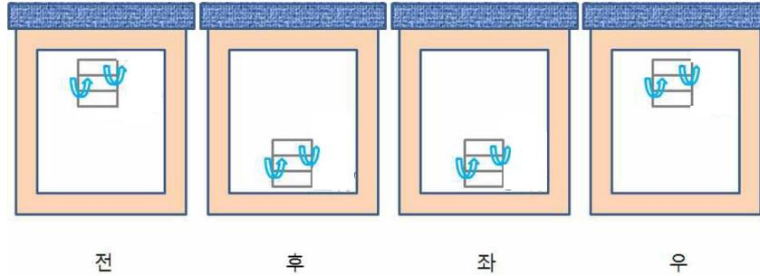
그림 2.8.9.1.1 정압기실 환기구의 설치 예
