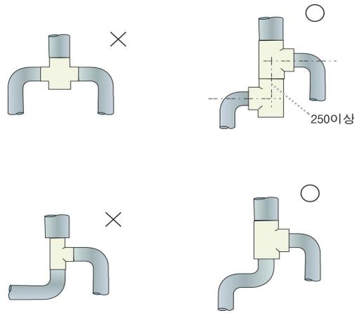
그림 2.7.1.3.1② 복합 배기통의 설치 예
