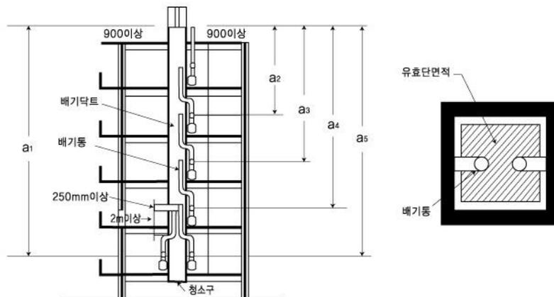
그림 A3 공동배기구의 설치 예
