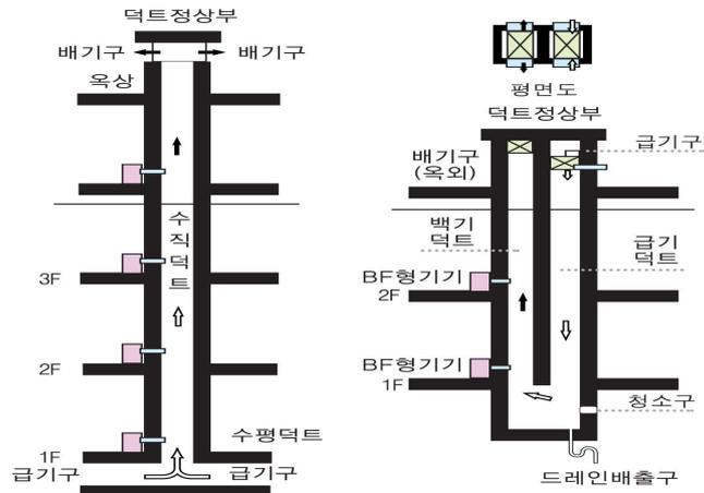
그림 2.7.1.4.2. SE 및 U덕트의 설치 예
