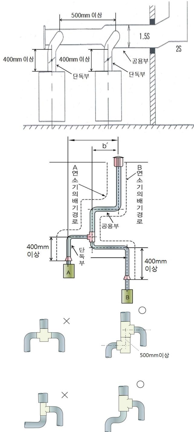
그림 2.7.1.3.2 복합 배기통의 설치 예
