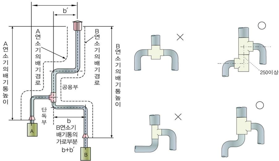
그림 A2 복합 배기통의 설치 예
