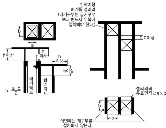
그림 A5 U덕트의 설치 예
