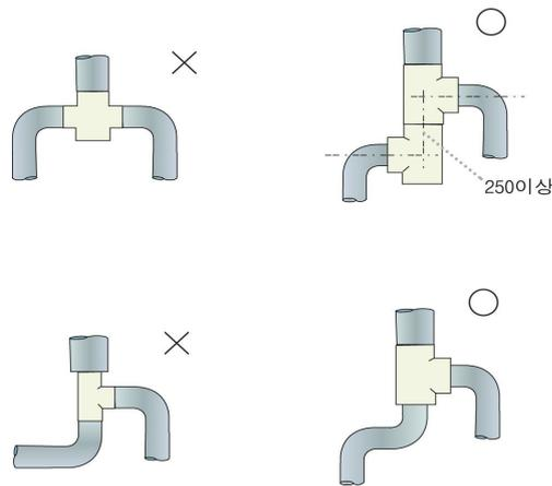
그림 2.7.1.3.1② 복합 배기통의 설치 예
