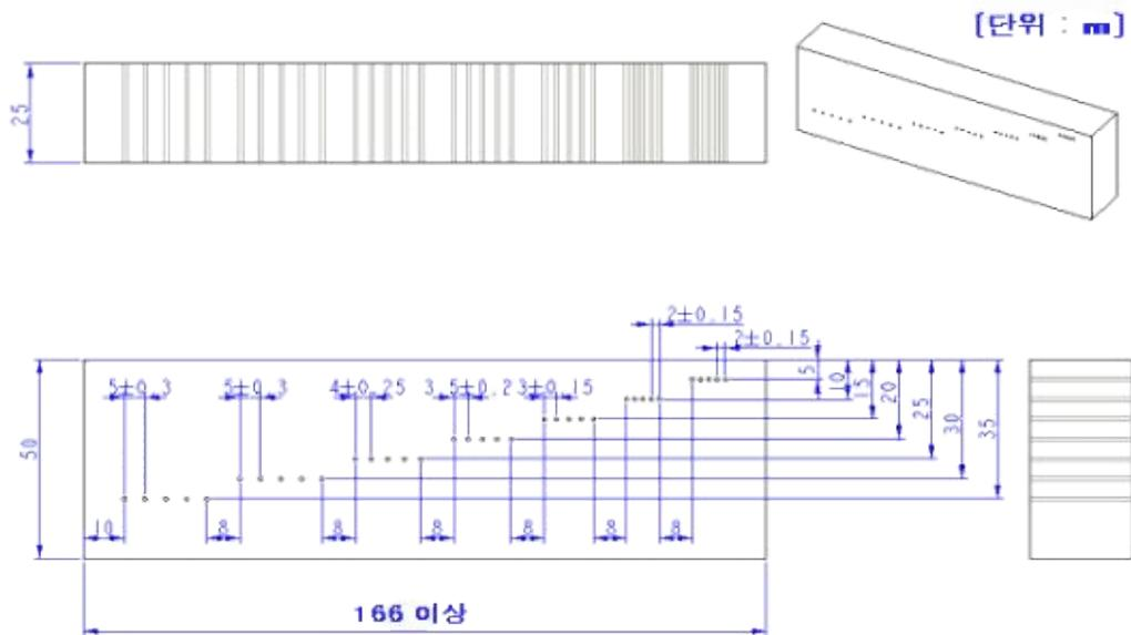
그림 B7.3 초음파 영상시험 대비 시험편 (측정온도: 섭씨20도, 오차범위: 표B7.2참고)
