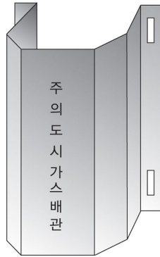
그림 2.5.8.3.1(4)① “ㄷ” 형태로 가공한 방호철판에 의한 방호구조물
