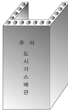
그림 2.5.8.3.3③ 철근콘크리트 방호조치
