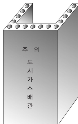
그림 2.5.8.3.3③ 철근콘크리트 방호조치
