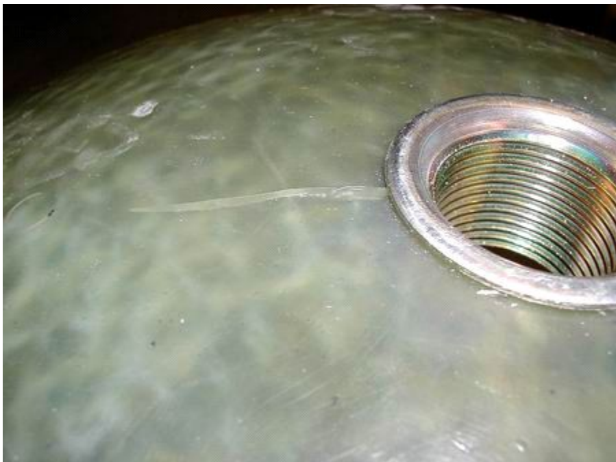
그림 3 복합재료부 외부 수지층에 있는 표면균열 - 이런 손상은 허용됨
