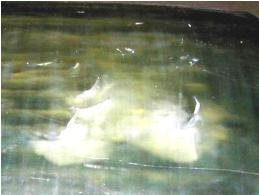
그림 5 표면결함과 연결된 층상박리 - 허용되지 않는 손상
