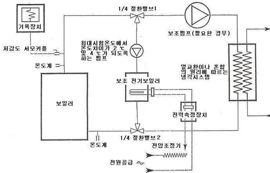
그림 F2. 대기손실(Standby losses) 측정하는 시험장치
