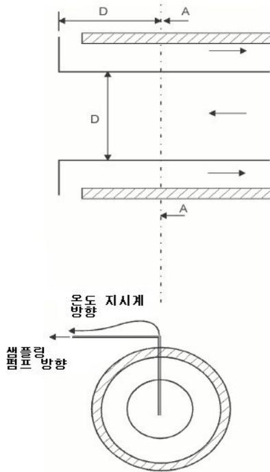
그림 D3. Type C 보일러의 측정관 위치
