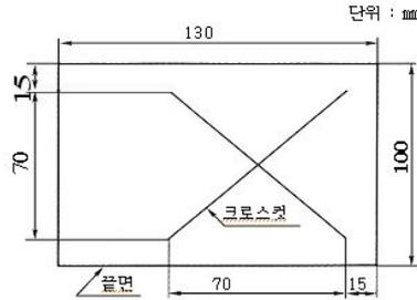
그림 3.4.2.2 표면에 내식처리를 한 금속재료의 내식성시험 시험편
