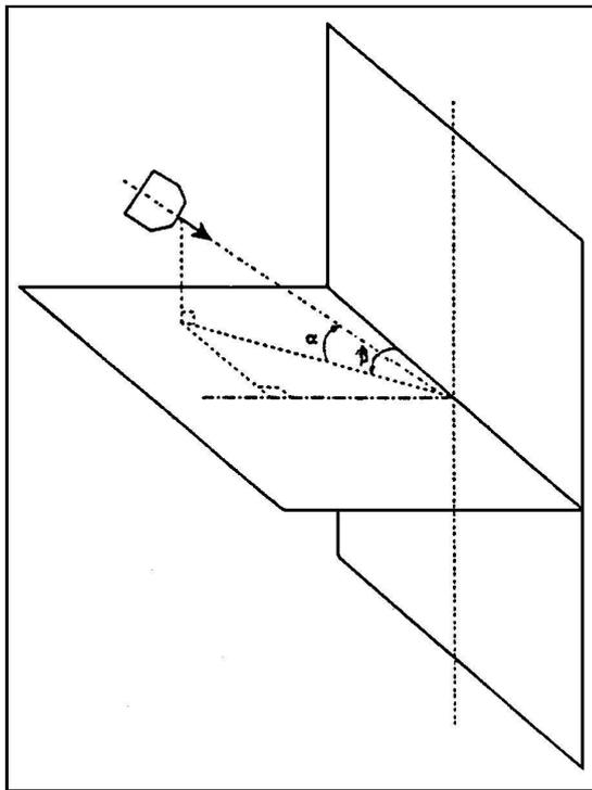
[비고] 1.  $\alpha = 0^\circ$  (수평 방향으로 인가하는 바람),  $+30^\circ$  및  $30^\circ$
