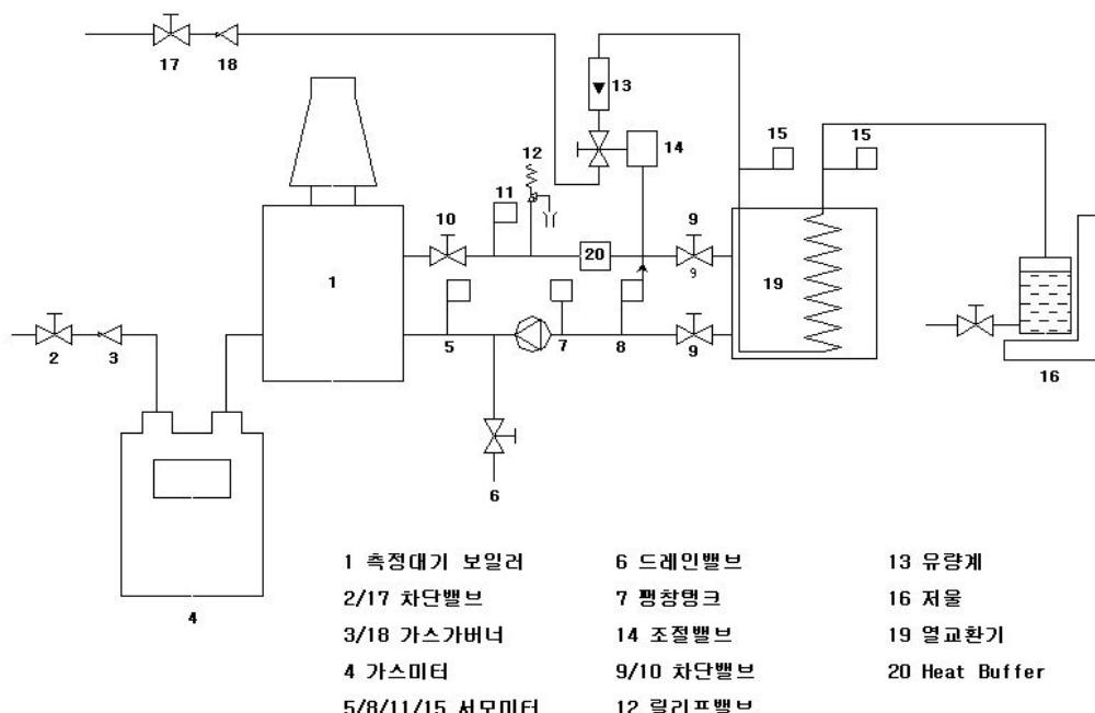
그림 F1. 효율시험 장치
