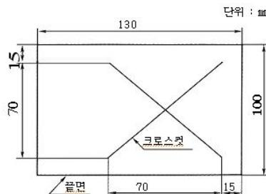
그림 3.4.2.2 표면에 내식처리를 한 금속재료의 내식성시험 시험편
