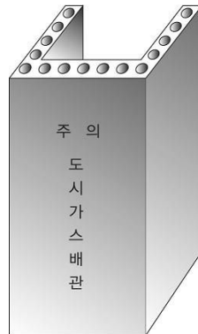
그림 2.5.4.3.3③ “C” 형태의 철근콘크리트재 방호구조물
