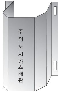
그림 2.5.4.3.3① “C” 형태로 가공한 방호철판에 의한 방호구조물
