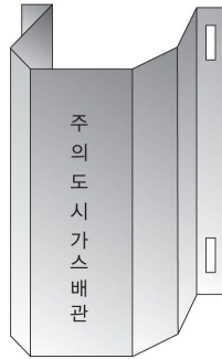
그림 2.5.4.3.3① “ㄷ” 형태로 가공한 방호철판에 의한 방호구조물
