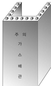
그림 2.5.7.6.11(2)③ “ㄷ” 형태의 철근콘크리트제 방호구조물에 의한 방호조치
