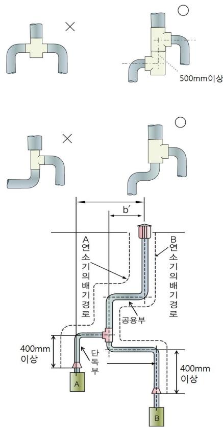
그림 2.7.1.3.2 복합 배기통의 설치 예
