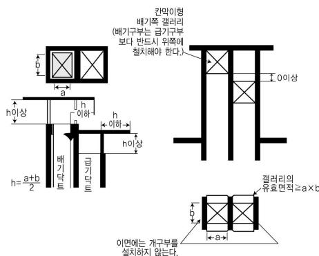
그림 B3.2.3.3.6② U-닥트의 설치 예시
