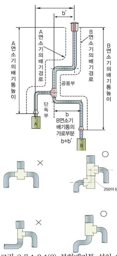
그림 2.7.1.3.1(3) 복합배기통 설치 예
