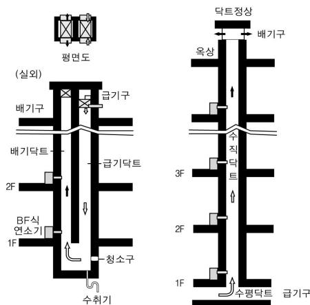
그림 B3.2.3.3.6① SE 및 U-닥트의 설치 예시
