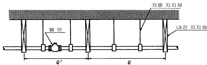
그림 F9.3 밸브 설치 시 지지의 예
