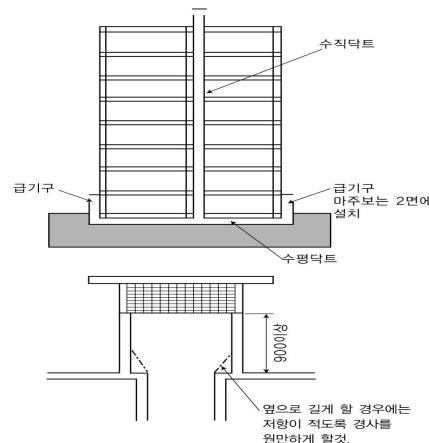
그림 B3.2.3.3.6③ SEダクト의 설치 예시
