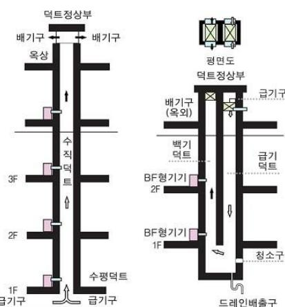
그림 2.7.1.4.2(3) SE 및 U 덕트 설치 예시
