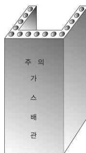
그림 2.5.7.6.9(2)(3) “ㄷ” 형태의 철근콘크리트제 방호구조물에 의한 방호조치
