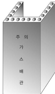
그림 2.5.7.6.9(2)③ “ㄷ” 형태의 철근콘크리트제 방호구조물에 의한 방호조치
