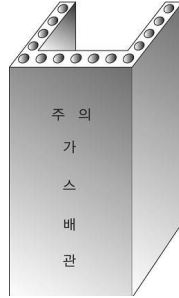
그림 2.5.7.6.9(2)③ “ㄷ” 형태의 철근콘크리트제 방호구조물에 의한 방호조치
