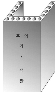
그림 2.5.8.3.2(3) 철근콘크리트재 방호구조물 예시
