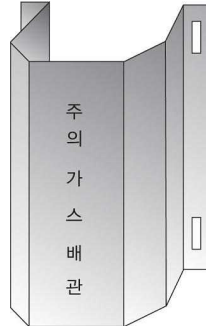
그림 2.5.7.3.2(1) 방호철판을 사용한 방호구조물 예시
