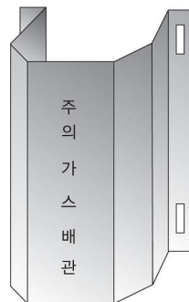
그림 2.5.8.3.2(1) 방호철판을 사용한 방호구조물 예시
