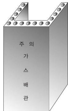
그림 2.5.8.3.2(3) 철근콘크리트재 방호구조물 예시
