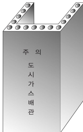
그림 2.5.7.3.3③ 철근콘크리트 방호조치
