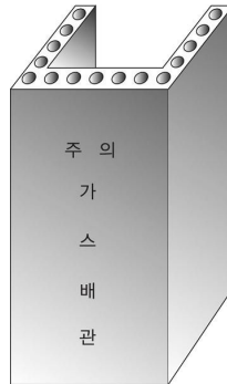
그림 2.5.7.3.2(3) 철근콘크리트제 방호구조물 예시
