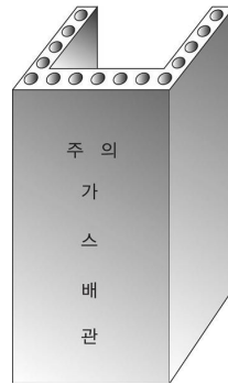
그림 2.5.7.3.2(3) 철근콘크리트재 방호구조물 예시
