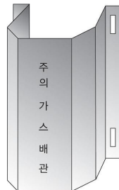
그림 2.5.7.3.2(1) 방호철판을 사용한 방호구조물 예시
