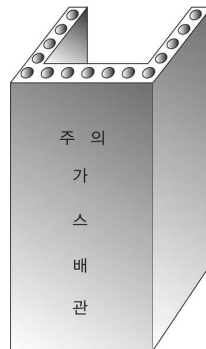
그림 2.5.7.3.2(3) 철근콘크리트제 방호구조물 예시
