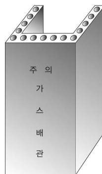
그림 2.5.7.3.2(3) 철근콘크리트재 방호구조물 예시
