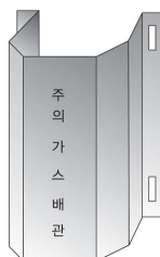
그림 2.5.7.3.2(1) 방호철판을 사용한 방호구조물 예시
