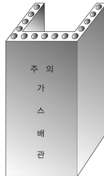
그림 2.5.7.3.2(3) 철근콘크리트재 방호구조물 예시
