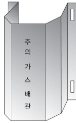
그림 2.5.7.3.2(1) 방호철판을 사용한 방호구조물 예시
