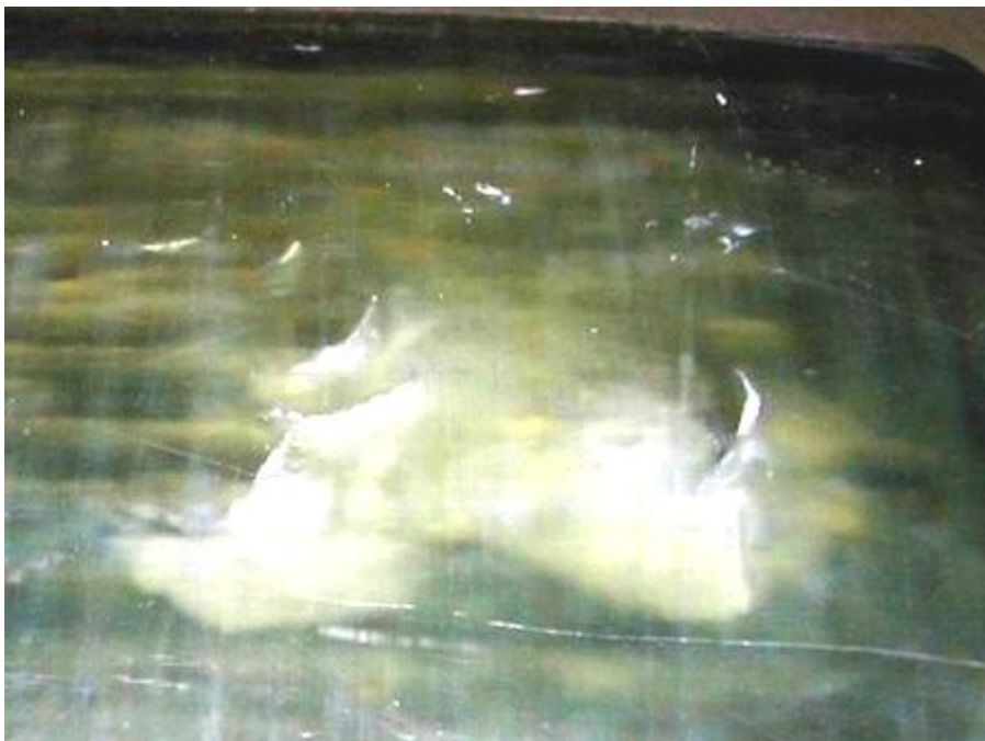
그림 5 표면결함과 연결된 층상박리 - 허용되지 않는 손상
