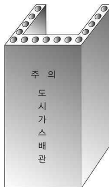
그림 2.5.4.3.3③ “ㄷ” 형태의 철근콘크리트재 방호구조물
