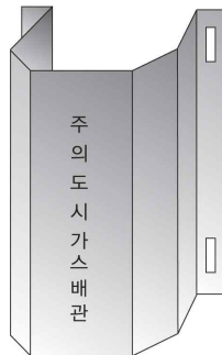
그림 2.5.4.3.3① “ㄷ” 형태로 가공한 방호철판에 의한 방호구조물
