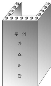
그림 2.5.7.6.9(2)③ “ㄷ” 형태의 철근콘크리트제 방호구조물에 의한 방호조치
