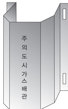
그림 2.5.8.3.1(4)① “ㄷ” 형태로 가공한 방호철판에 의한 방호구조물
