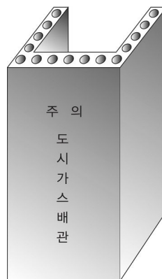
그림 2.5.8.3.1(4)③ “ㄷ” 형태의 철근콘크리트재 방호구조물
