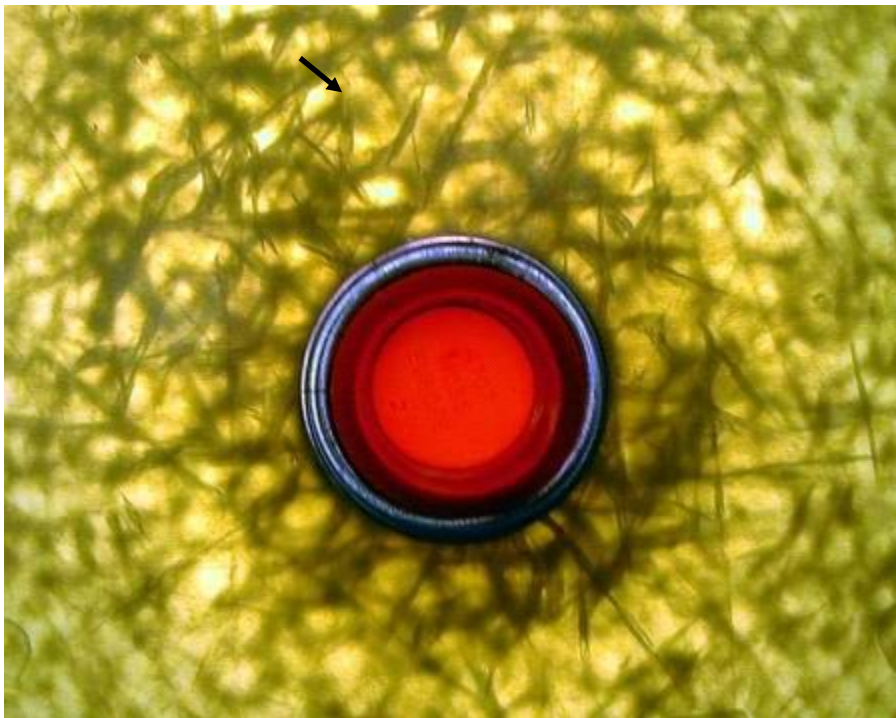
그림 7 끝부분의 어두워짐 - 이 경우 용기 끝부분인 넥 개구부 주위의 섬유 교차부분 어두운 점이 보인다. 이런 결함을 가진 용기는 폐기해야 함
