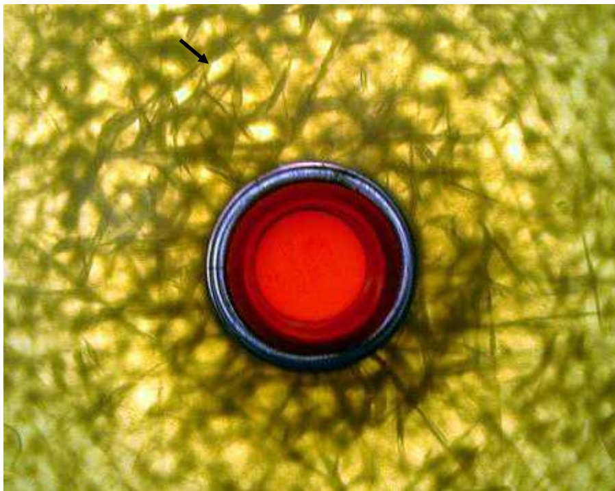
그림 7 끝부분의 어두워짐 - 이 경우 용기 끝부분인 넥 개구부 주위의 섬유 교차부분 어두운 점이 보인다. 이런 결함을 가진 용기는 폐기해야 함
