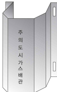
그림 2.5.4.3.3① “ㄷ” 형태로 가공한 방호철판에 의한 방호구조물
