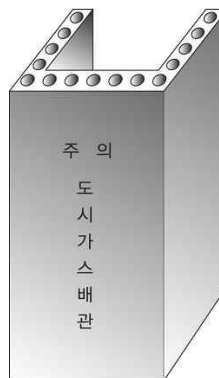
그림 2.5.4.3.3③ “ㄷ” 형태의 철근콘크리트재 방호구조물
