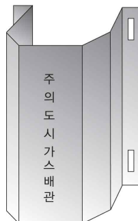
그림 2.5.4.3.3① “ㄷ” 형태로 가공한 방호철판에 의한 방호구조물
