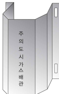
그림 2.5.4.3.3① “ㄷ” 형태로 가공한 방호철판에 의한 방호구조물
