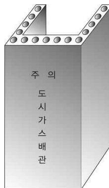
그림 2.5.4.3.3③ “ㄷ” 형태의 철근콘크리트재 방호구조물
