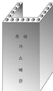
그림 2.5.7.6.11(2)③ “ㄷ” 형태의 철근콘크리트제 방호구조물에 의한 방호조치
