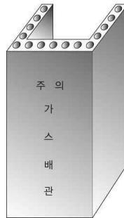
그림 2.5.7.6.9(2)③ “ㄷ” 형태의 철근콘크리트제 방호구조물에 의한 방호조치
