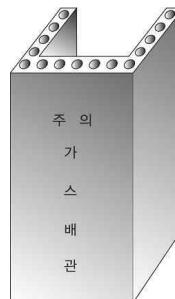
그림 2.5.7.6.9(2)③ “ㄷ” 형태의 철근콘크리트제 방호구조물에 의한 방호조치
