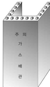
그림 2.5.7.6.9(2)③ “ㄷ” 형태의 철근콘크리트제 방호구조물에 의한 방호조치
