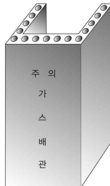
그림 2.5.8.3.2(3) 철근콘크리트재 방호구조물 예시
