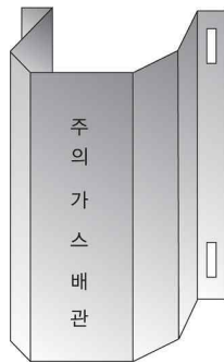
그림 2.5.7.3.2(1) 방호철판을 사용한 방호구조물 예시
