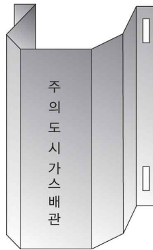
그림 2.5.8.3.1(4)① “ㄷ” 형태로 가공한 방호철판에 의한 방호구조물
