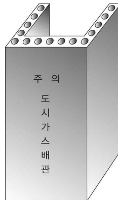
그림 2.5.8.3.1(4)③ “ㄷ” 형태의 철근콘크리트재 방호구조물
