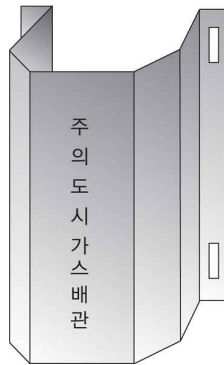
그림 2.5.8.3.1(4)① “ㄷ” 형태로 가공한 방호철판에 의한 방호구조물
