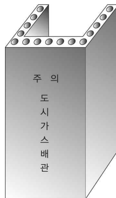
그림 2.5.8.3.1(4)③ “ㄷ” 형태의 철근콘크리트재 방호구조물
