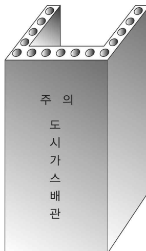
그림 2.5.8.3.3③ 철근콘크리트 방호조치
