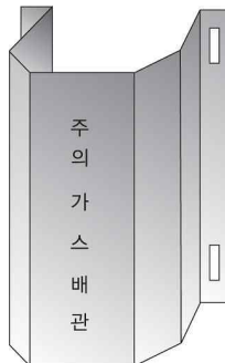
그림 2.5.8.3.2(1) 방호철판을 사용한 방호구조물 예시
