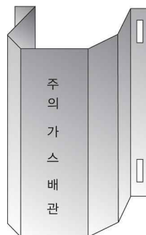
그림 2.5.8.3.2(1) 방호철판을 사용한 방호구조물 예시
