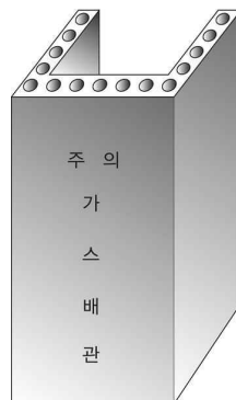
그림 2.5.8.3.2(3) 철근콘크리트재 방호구조물 예시
