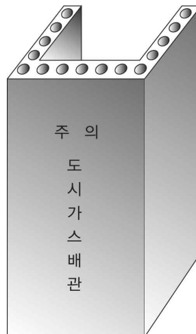
그림 2.5.7.3.3③ 철근콘크리트 방호조치
