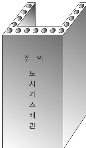
그림 2.5.7.3.3③ 철근콘크리트 방호조치
