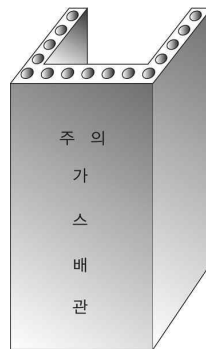
그림 2.5.7.3.2(3) 철근콘크리트재 방호구조물 예시
