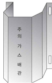
그림 2.5.7.3.2(1) 방호철판을 사용한 방호구조물 예시
