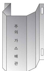
그림 2.5.7.3.2(1) 방호철판을 사용한 방호구조물 예시
