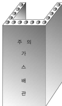
그림 2.5.7.3.2(3) 철근콘크리트재 방호구조물 예시
